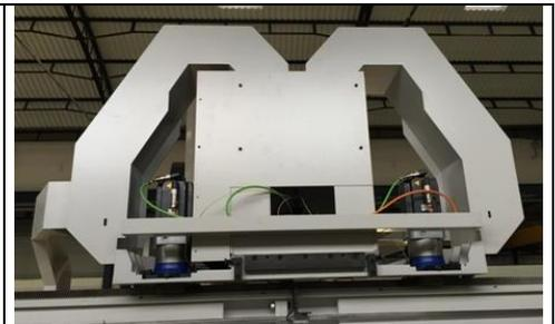
**Il carro che scorre sulla traversa , asse trasversale X, è gestito da due motori.**
