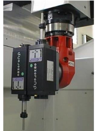
La particolare forma della testa che porta l'asse del mandrino a 233 mm dal centro dell'asse verticale, consente la lavorabilità nel piano, di dimensioni superiori alla corsa assi X, Y di oltre 400 mm
