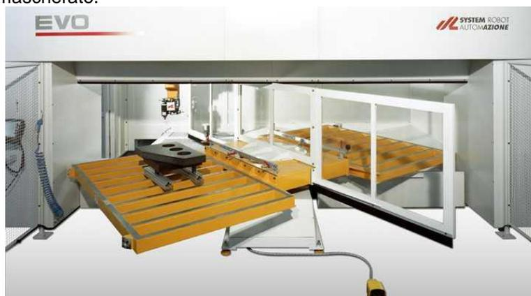
I due piani sono in carpenteria con struttura reticolare elettrosaldata, normalizzata, lavorata e verniciata, completa di fori filettati per il posizionamento ed il bloccaggio dei portapezzi.
